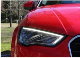
**Luz de Posición:** iluminación del vehículo para que seamos vistos, tanto por delante como por detrás.
